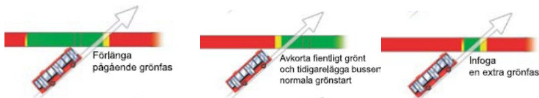
Figur 29 Exempel på prioriteringsfunktioner i PRIBUSS.
